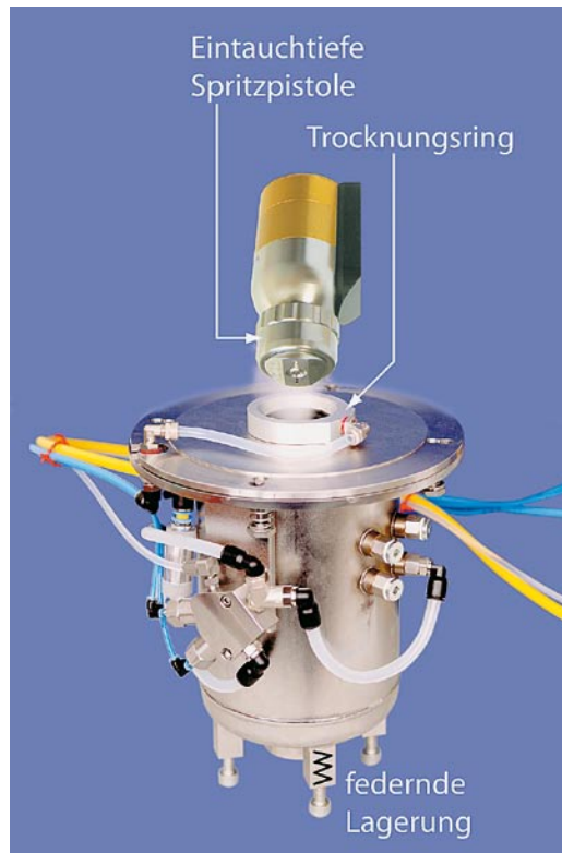
Das Gerät ohne Gehäuse. Die federnde Lagerung gleicht Toleranzen bei der Positionierung aus.
